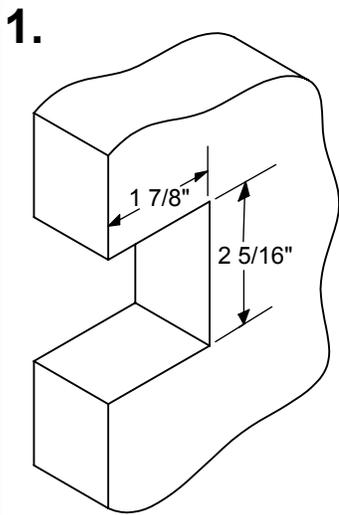
1. CUT NOTCH IN THE DOOR AT THE DESIRED HEIGHT.
