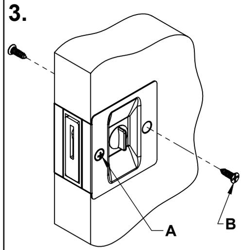
3. A. TIGHTEN MACHINE SCREWS TO AUTOMATICALLY ALIGN THE PULL ON THE DOOR.
