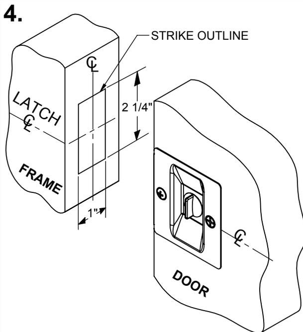
4. MARK LATCH CENTERLINE ON FRAME SO THE LATCH AND STRIKE LINE UP. USING THE CENTERLINES AS A GUIDE, MARK AROUND THE STRIKE. MORTISE THE STRIKE OUTLINE WITH A CHISEL 3/64" DEEP.
