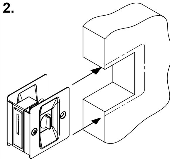
2. SLIDE THE LATCH INTO PLACE SO THAT THE FRONT FACE OF THE LATCH IS FLUSH WITH THE DOOR EDGE.
