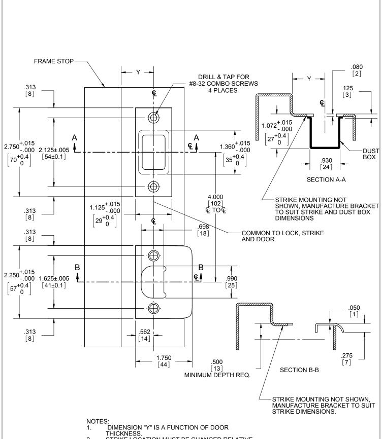
2. STRIKE LOCATION MUST BE CHANGED RELATIVE TO THICKNESS OF DOOR SILENCER OR WEATHERSTRIPPING WHEN USED.
