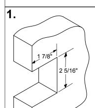
CUT NOTCH IN THE DOOR AT THE DESIRED HEIGHT.
