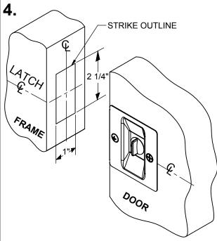
MARK LATCH CENTERLINE ON FRAME SO THE LATCH AND STRIKE LINE UP. USING THE CENTERLINES AS A GUIDE, MARK AROUND THE STRIKE. MORTISE THE STRIKE OUTLINE WITH A CHISEL 3/64" DEEP.
