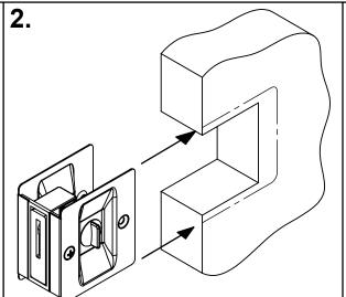
SLIDE THE LATCH INTO PLACE SO THAT THE FRONT FACE OF THE LATCH IS FLUSH WITH THE DOOR EDGE.
