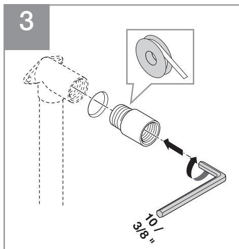
**us** Caulk the residual opening to make watertight. **es** Sellar el orificio para impermeabilizarlo. **fr** Obturer les ouvertures superflues pour rendre étanche.
